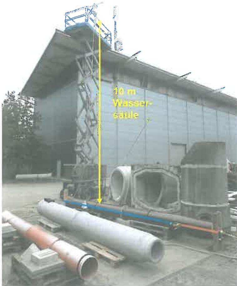
Bild 10: Prüfaufbau für die Dichtheitsprüfung mit 1,0 bar (10m Wassersäule)
