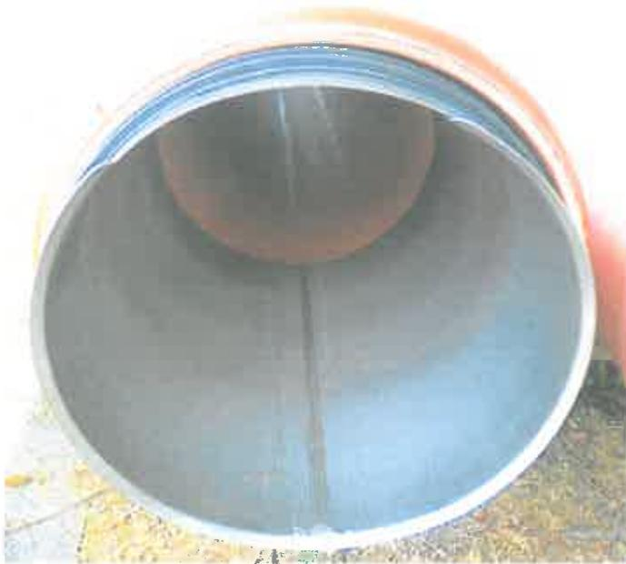
Bild 11: Circum-MINI Innenrohrmanschette DN 300 nach 60 Zyklen
