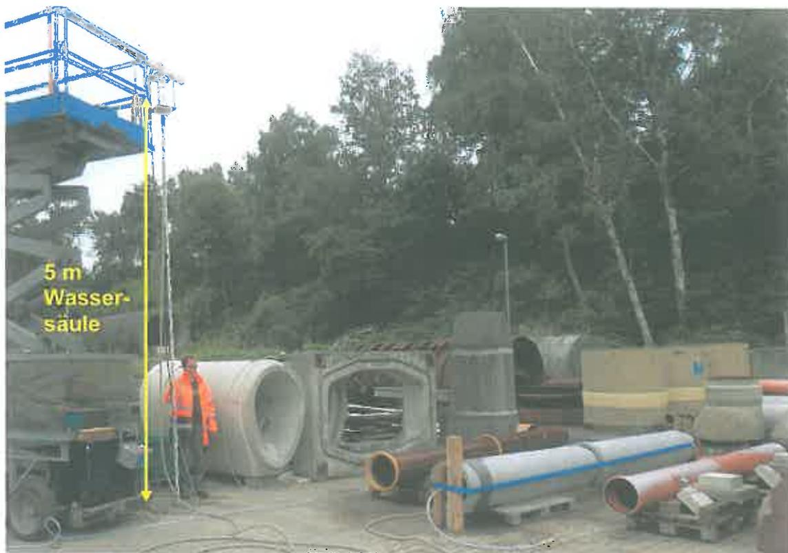
Bild 9: Prüfaufbau für die Dichtheitsprüfung mit 0,5 bar (5m Wassersäule)
