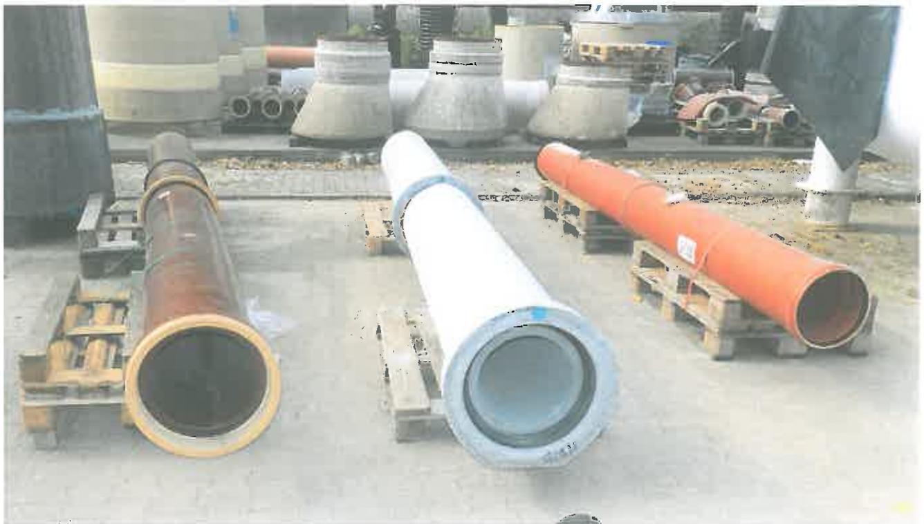
Bild 2: Prüfstrecke 1 (Steinzeug-Steinzeug), Prüfstrecke 2 (Beton-Beton) und Prüfstrecke 3 (PVC-PVC) DN 300
