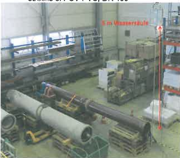
Bild 7: Dichtungsprüfung unter Scherlast, Versuchsstrecke 4: Beton-Beton, DN 400
