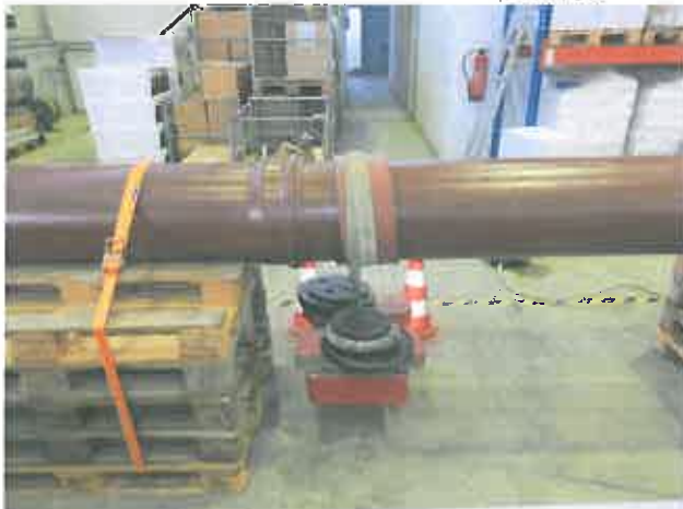
Bild 5: Scherlasteinwirkung an der Versuchsstrecke 3: PCV-PVC, DN 400
