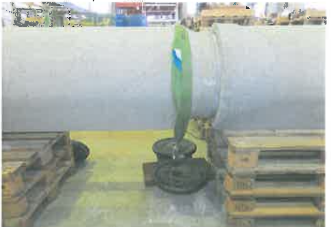
Bild 6: Scherlasteinwirkung an der Versuchsstrecke 4: Beton-Beton, DN 400
