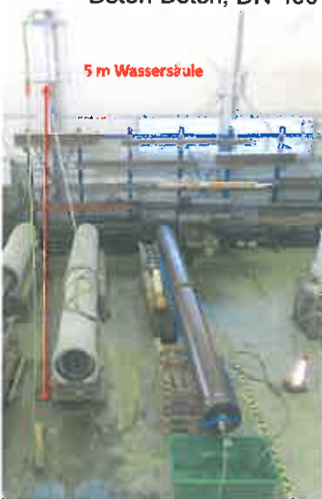
Bild 8: Dichtungsprüfung, Versuchsstrecke 3: PVC-PVC, DN 400
