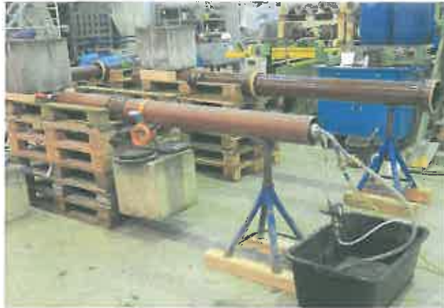
Bild 3: Dichtungsprüfung unter Scherlast, Versuchsstrecke 1: PVC-PVC, DN150
