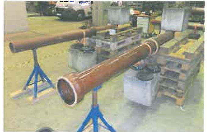
Bild 4: Scherlasteinwirkung an den Versuchsstrecken 1 und 2, DN 150
