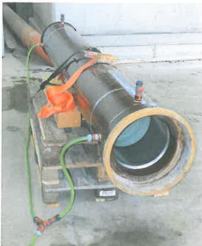
Bild 6: Außenwasserdruckversuch an den Linerendmanschetten im Steinzeugrohr
