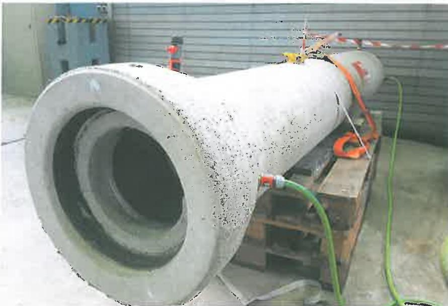
Bild 3: Außenwasserdruckversuch an den Linerendmanschetten im Betonrohr
